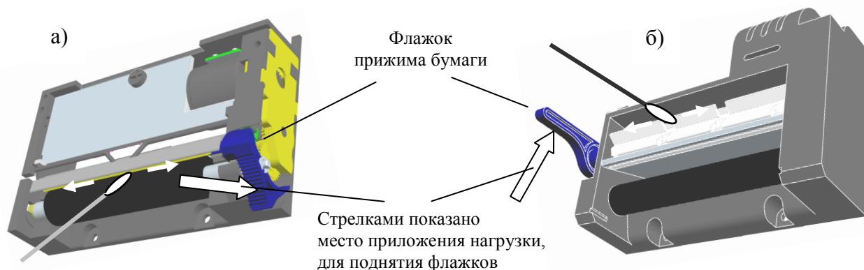
Рис. 28 - Чистка термоголовки принтера
