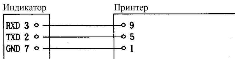
Рис. 15 Распайка для подключения принтера «CAS»
