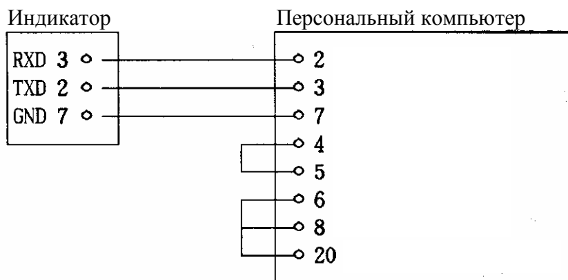
Рис. 11 Распайка для 25-ти контактного разъема
