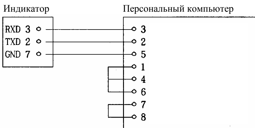
Рис. 12 Распайка для 9-ти контактного разъема
