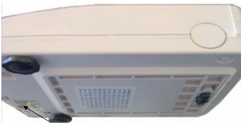
Место нанесения клейма в виде наклейки (переключатель юстировки)
